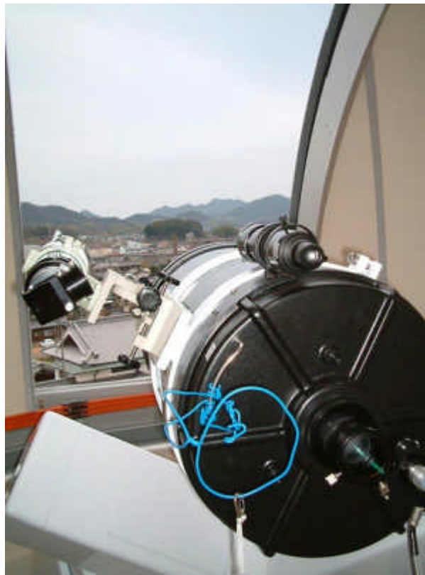
調整位置にて光軸一致作業中
