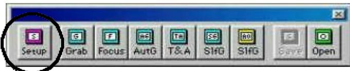
アイコンバーの左の、『SET Up』をクリックします。新たにダイアログが表示されますのでそのなかの温度制御を以下のように設定します。
