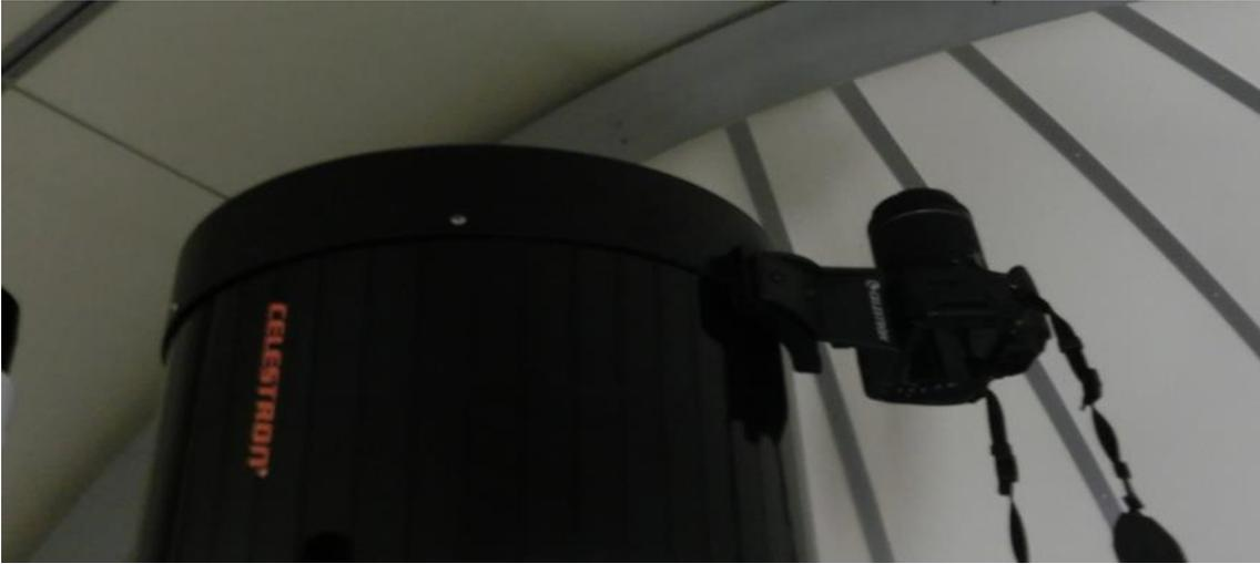
鏡筒は使わず、カメラを赤道儀に搭載して撮影する方法です。広角または標準レンズを取り付けたカメラで広範囲の星空を撮影した写真が星の野原のようにみえることから星野写真とよばれています。星座全体や天の川を撮影する時などに使います。
