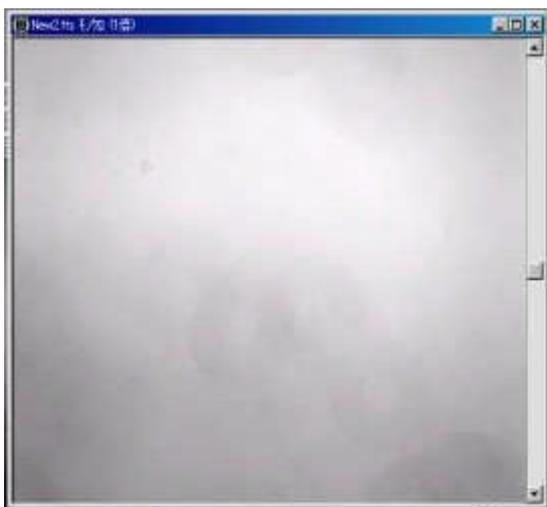
そこで露出時間を調整して、最適なフラットフィールドを得ます。露出時間の変更はアイコンバーの『Grab』をクリックし、撮像ダイアログの中の露出時間(E)を変更することで可能です。ただし、露出時間を変更する場合は後に同じ温度・露出時間の **ダークフレーム** を撮影する必要があります。
