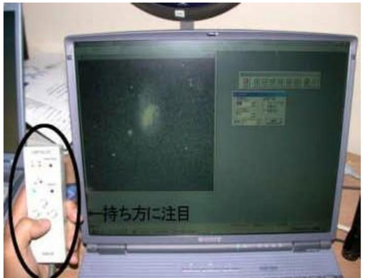
ハンドコントローラーを写真のように持つ事で、画像処理パソコンに表示された画像とハンドコントローラーの方向が一致します。ハンドコントローラーで右を押せば画像に移っている目標天体は右に移動します。
