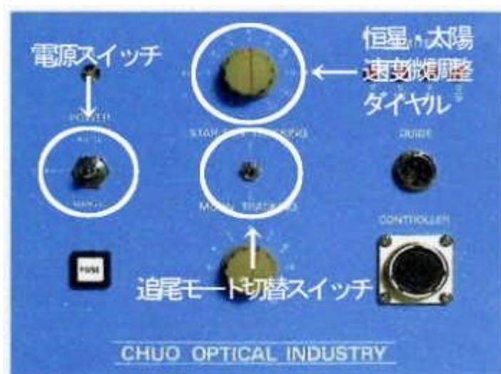
■赤道儀から異常な音がする場合は赤道儀の制御パネルの電源をOFFにします。もしくは天文台の電源（ナイフスイッチ）を切ります。
