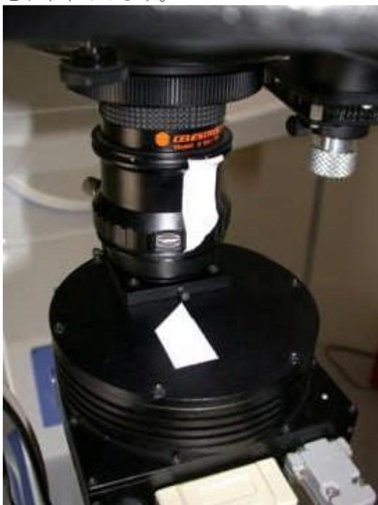
冷却 CCD カメラをはずしたら、スリーブに取り付けられている透明フィルターを外し、そこに赤・緑・青いずれかのフィルターをねじ込みます。色フィルターはぱっと見、色が分からないと思います。光にすかしてみると、赤フィルターなら赤色に見えますのでそうすることで各フィルターを識別してください。
